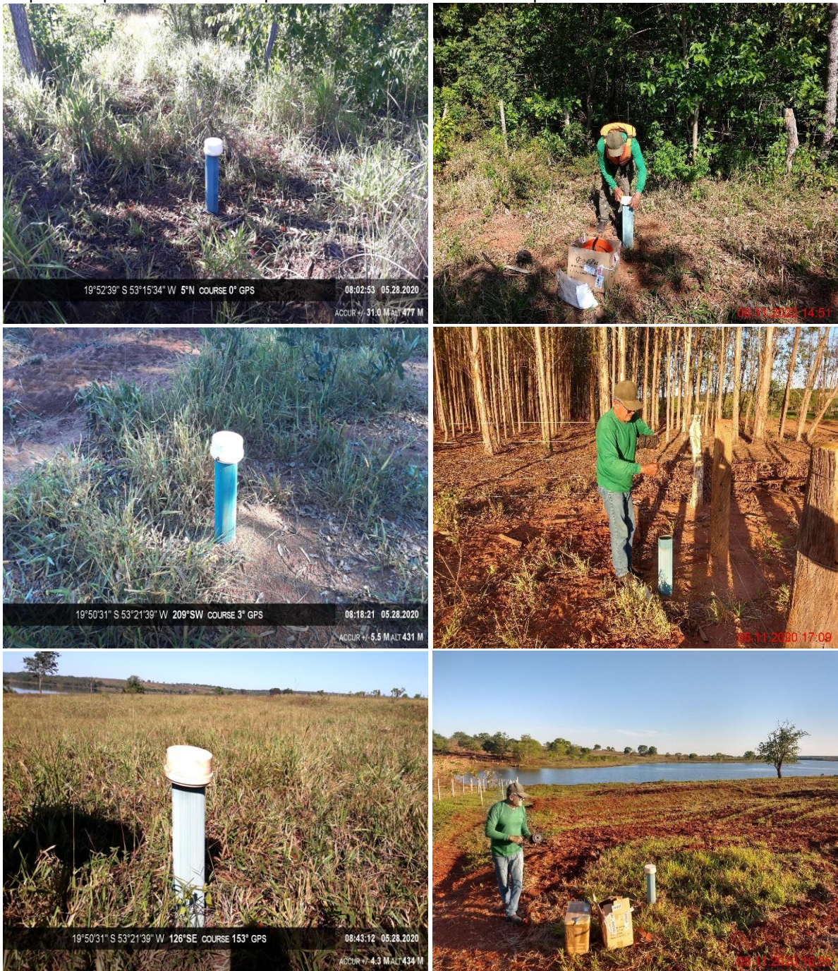
Figura 1 - Poços de monitoramento da PCH Verde 4A. Pontos de cima para baixo: P1 a P6. Figuras a esquerda representando a campanha de maio e a direita a campanha de novembro de 2020.
