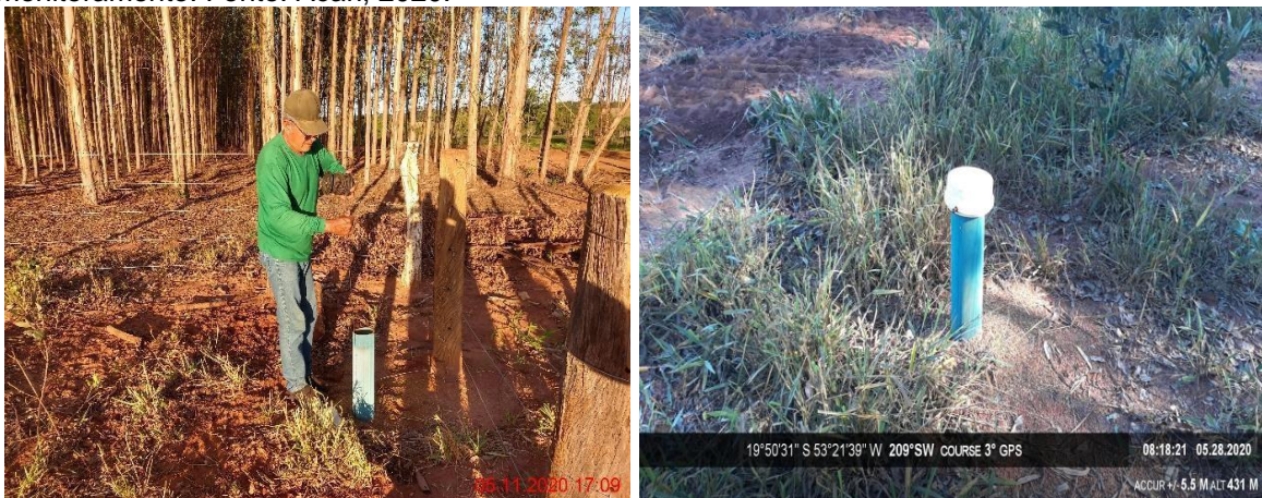
Figura 3 – Procedimentos de medição do nível d'água e de coleta de água dos poços de monitoramento. Fonte: Acari, 2020.
