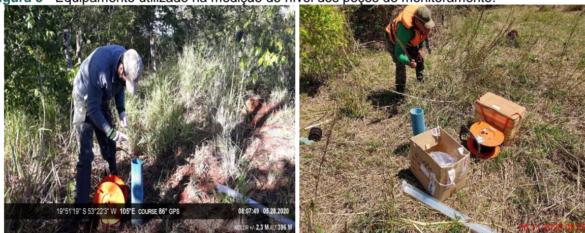
Figura 3 - Equipamento utilizado na medição do nível dos poços de monitoramento.
